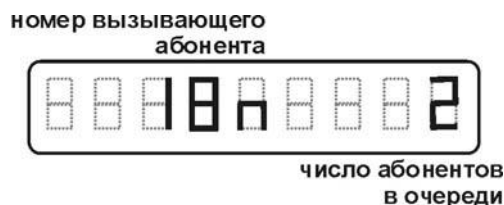
Рис.2а. Состояние индикатора при вызове с трубки.
