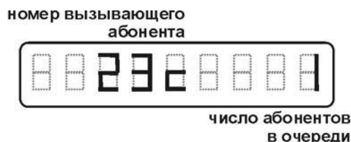
Рис.2б. Состояние индикатора при вызове с помощью кнопки вызова (КВ).
